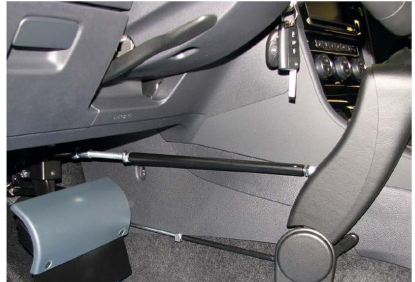
**Verbindung zum Handbediengerät**
