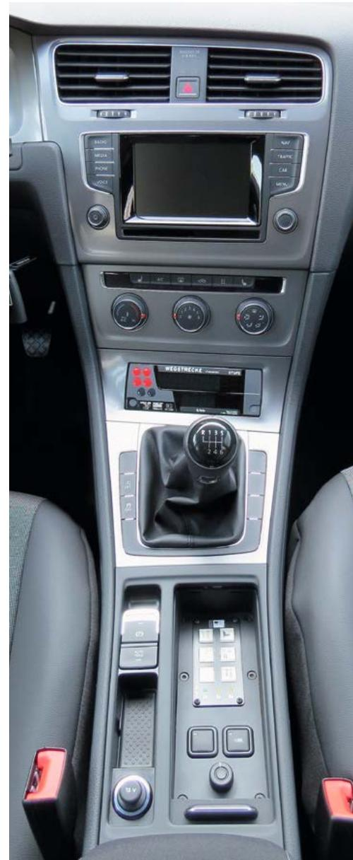
**Bedienelemente für Signaltonanlage, Funk und Wegstreckenzähler**
